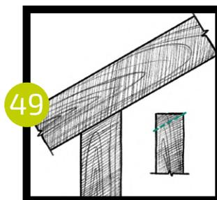
Нижний поручень нужно расположить так чтобы он лежал на ступенях. Это будет служить опорой, чтобы избежать прогибов (50). Одеваем балясины на универсальные крепежи нижнего поручня, затем надеваем верхний поручень.
