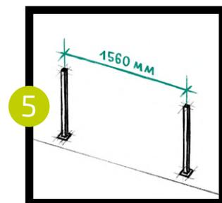
Определить высоту ограждения и, следовательно, всех элементов. Рекомендованная высота столба ограждения 964 мм с учетом толщины пильного диска 3 мм (7).
