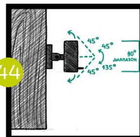
При монтаже поворотного крепления к столбу из ДПК, нужно отмерить и засверлить 4 отверстия для саморезов (45). ВАЖНО знать, что поворотное крепление для поручней фиксируется к металлическому кронштейну, а не к столбу из ДПК.
