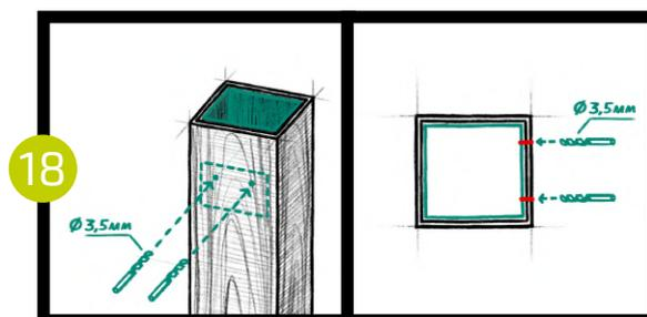
Далее нужно вкрутить в просверленные отверстия универсальные жёлтые саморезы размером 4,5x35 мм (19). Не затягивайте саморезы для возможности надевания и снятия крепления для поручня через специальные отверстия (20).
