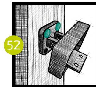
Монтаж наклонной секции с алюминиевыми балясинами производится по тому же принципу и последовательности, что и прямая секция с алюминиевыми балясинами. Только с угловым крепёжом из ABS пластика, имеющим угол в 33° (53).
