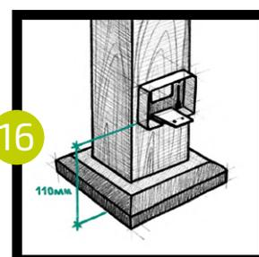
Размечаем и предварительно сверлим два отверстия для крепления поручня. Сначала просверливаем ДПК столб сверлом по дереву диаметром 5 мм, больше, чем сам шуруп (17). Потом просверливаем металлический кронштейн сверлом по металлу диаметром 3,5 мм, меньше, чем сам шуруп (18).
