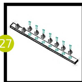
Для нижнего поручня крепления для балясин вкручиваются по тому же принципу и последовательности, что и для верхнего, но с другой стороны поручня (28).
