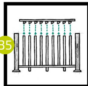
Крепления верхних перилл фиксируются к столбу саморезами размером 4,5\*35 мм через дополнительные отверстия, с предварительным засверливанием столба из ДПК сверлом диаметром 3,5 мм (36).
