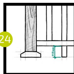
Для балясин из ДПК используется универсальное оцинкованное крепление. Расход на 1 секцию ограждения, длиной по поручню 1448 мм – 21 штука.
